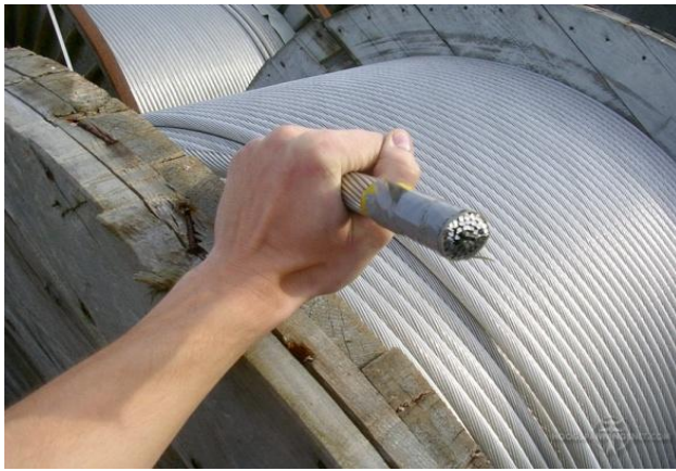
hoogspanningskabel van aluminium
