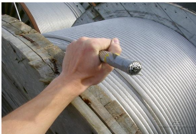
hoogspanningskabel van aluminium
